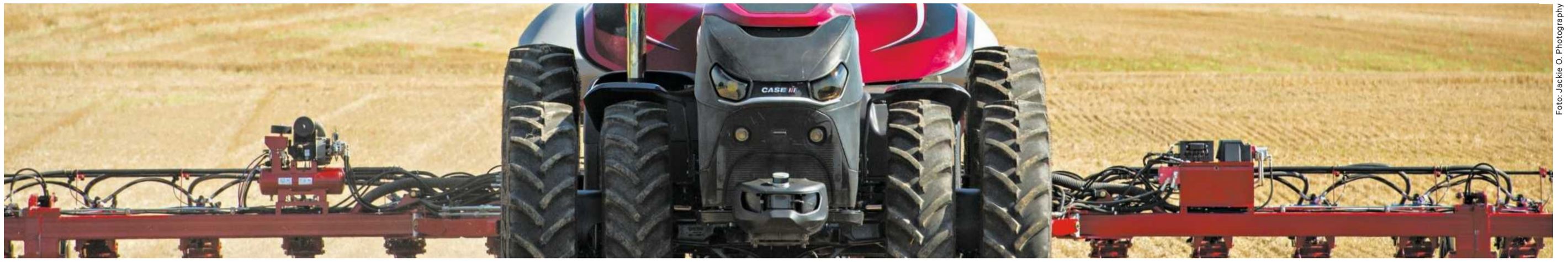
Dieser Trecker von Case fährt ohne Fahrer. Der Bauer steuert ihn vom Laptop aus
